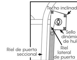
Montaje atrás de puerta seccional de andén
